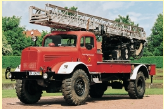
Bild 8 Ein absolutes Einzelstück ist diese 1958 von Metz für die Bundeswehr gebaute DL 25 auf einem allradangetriebenen MB LG 315. Das Fahrzeug stand später kurz bei der FF Siegelsbach und gehört heute einem Sammler.
