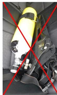
Atemluftflaschen müssen deshalb während des Transports so gelagert sein, dass diese auch bei einer Vollbremsung weder verrutschen noch sich unkontrolliert im Ladungsraum hin und her bewegen können. Dies kann durch Verzurren mittels eines oder mehrerer Zurrgurte geschehen. Es empfiehlt sich, hier zusätzlich eine rutschhemmende Matte zu verwenden. Auf den Ventilschutz ist besonderes Augenmerk zu richten.
