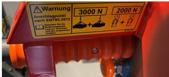
Kennzeichnung der Belastungsart Firma Rosenbauer
