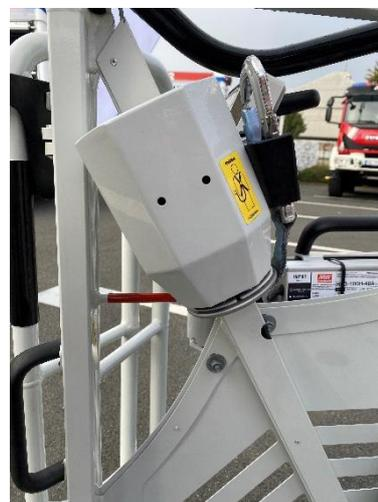
Höhensicherungsgerät am Rettungskorb
